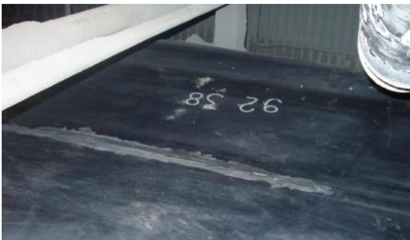
шероховатую поверхность препаратом **F-7**. Этот препарат втирается влажной чистой тряпкой до получения заметного почернения поверхности.
